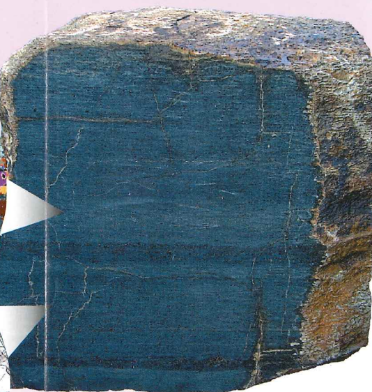
斜長石レゾライト (Plagioclase Lherzolite) は単斜輝石を多く含むかんらん岩で、多量のマグマを生成することができます。鉄やチタンに富むため、暗い紫色を呈します。平行な2枚の層は斜方輝石と単斜輝石からなる輝岩 (きがん, Pyroxenite) です。
